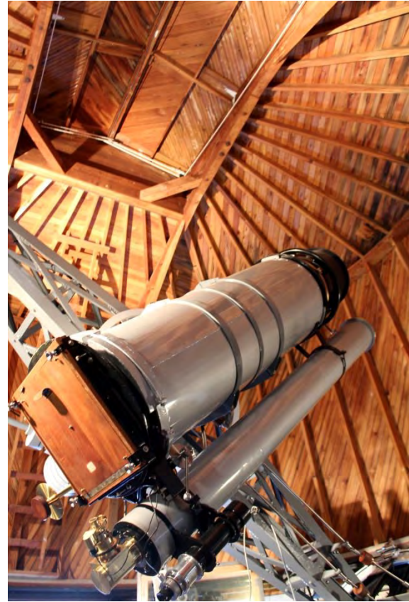
El Pluto Discovery Telescope de 32,5 cm de diámetro. El telescopio que sirvió para el descubrimiento de Plutón.
