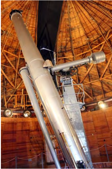
El Clark Telescope, refractor de 61 cm de diámetro.
